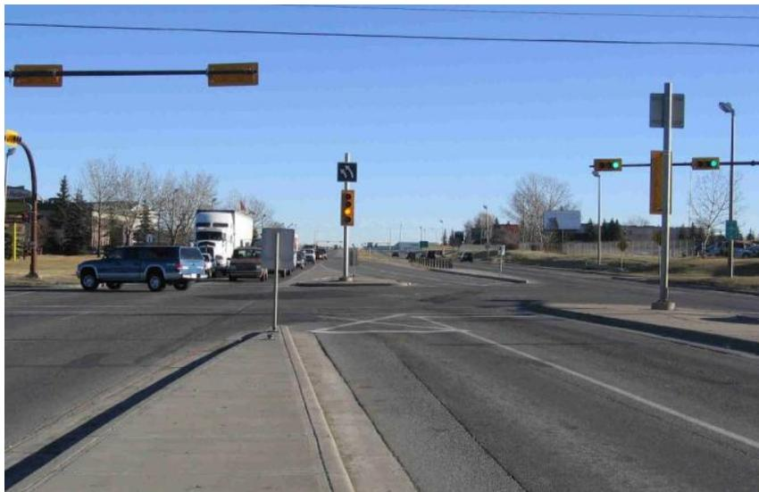
FIGURE 3.17 DUAL POSITIVE OFFSET LEFT-TURN LANE (SUBURBAN)
