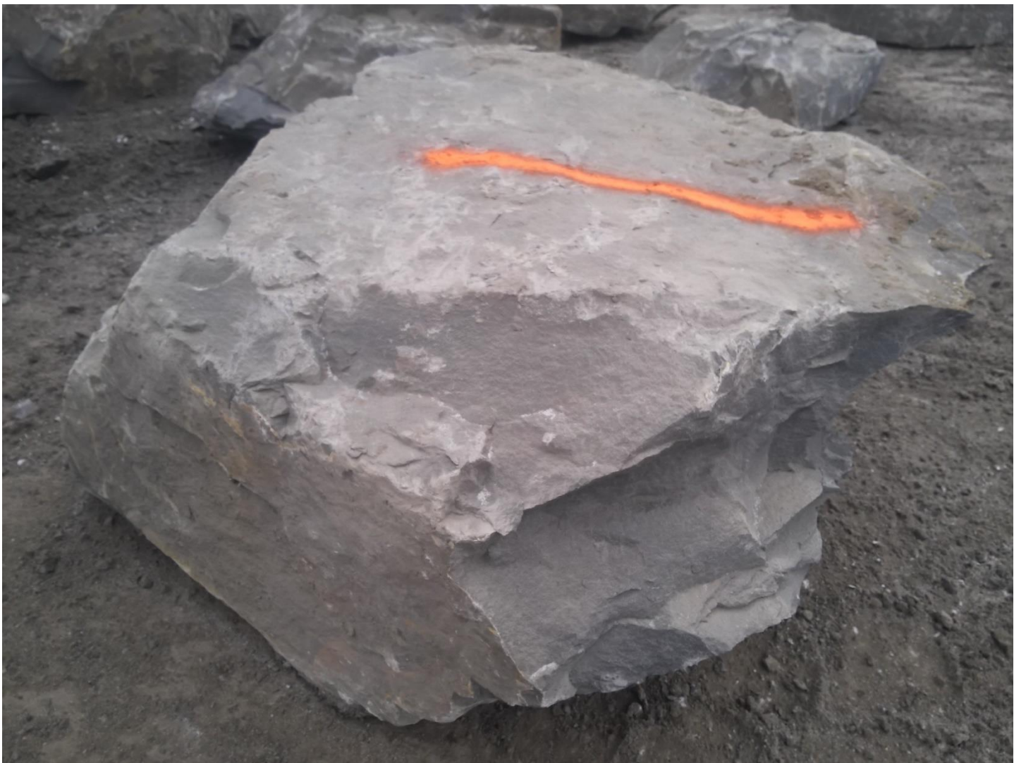
Greywacke - Good riprap
